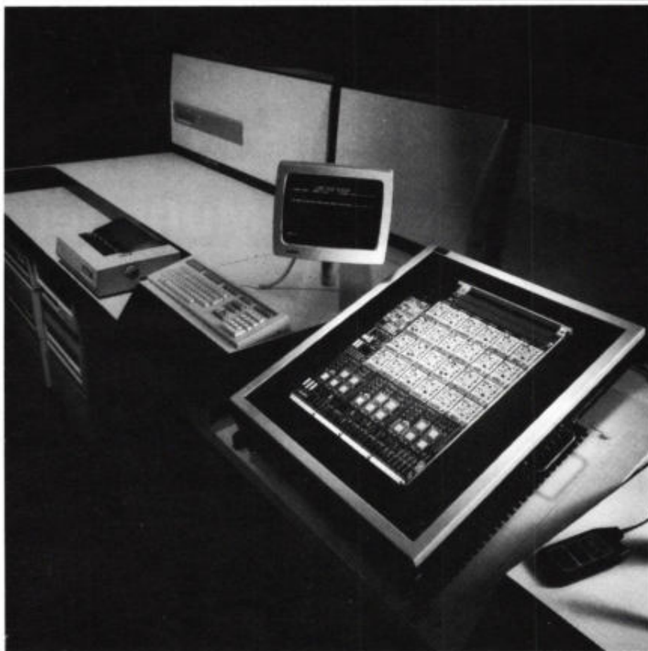
Teradyne's L280, een modern hybride kaart-teststelsysteem voor het beproeven van kaarten met analoge en digitale functies. Dit kan plaatsvinden door methoden voor functioneel beproeven te combineren met in-circuit-methoden.
