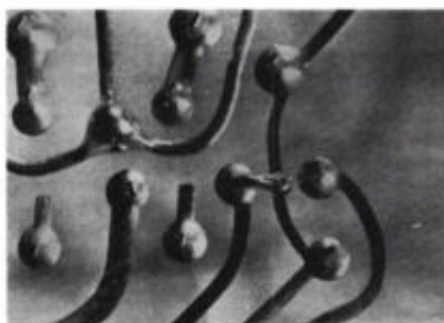
Verbogen pennen en aansluitdraden van componenten kunnen kortsluiting veroorzaken.
