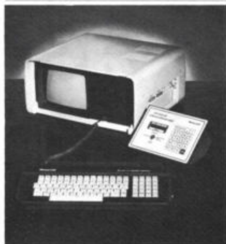
Afb. 4. Draagbaar werkstation IPC623-50 met monochroom 9-inch beeldscherm, bestemd als universeel station voor programmerings- en observatietaken bij de IPC620-familie. Het losse ASCII-toetsenbord kan men desgewenst rechtstreeks aansluiten op één van de industriële microcomputers van het IPC620-systeem (geldt niet voor het type 627-1000).
