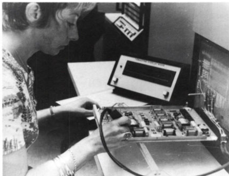
Werkplek van de operator van een vroeger systeem voor functioneel beproeven. De te beproeven kaart is in de connector van een moederprint van het testsysteem gestoken. Gesouffleerd door een display, tast de operator met een meetpen bepaalde punten van de kaart af. (Foto: Teradyne).
